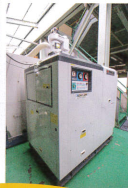
上/高圧クーラントによる噴射の様子。水道の蛇口を一杯ひねった状態の約200倍の水圧! 右/これが高圧クーラントだ
