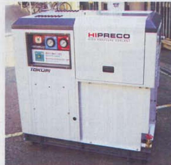
切削刃・工具の寿命が格段に伸び、作業スピードがアップするトクビ製作所の高压クーラントユニット
