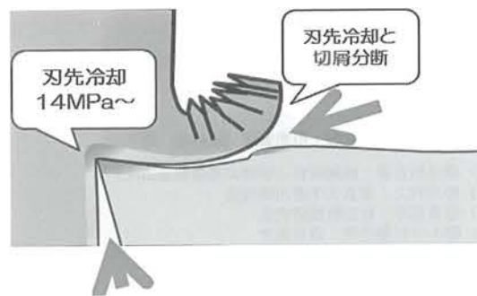
図8 刃先冷却と生産性
