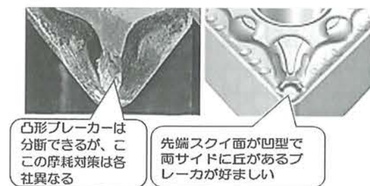
図6 中切削に最適なブレイカ
