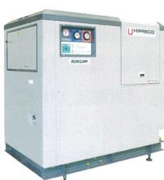
超高压クーラントは難削材などの切削加工において、刃先近傍にあけられたノズルから、切削油を高圧で噴射することにより、切りくずを細かく分断すると共に、刃先を確実に冷却する。このことにより生産性を大幅に向上（試算では1.7倍）させるものである。
