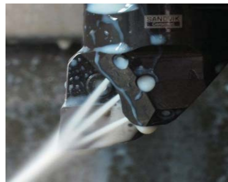
図3 高圧クーラント刃先近傍の様子
